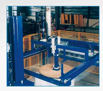
Drehteller mit Stahlblechabdeckung und Speziallagerung. Strechsäule aus gekannteten Stahlblechprofilen mit Hubantrieb für vertikal verfahrbares Strechaggregat mit Folienklemm-Konus, Umlenkwalzen und mechanischem oder elektronisch gesteuertem Folienvorrecksystem. In Strechsäule integriertes Bedienterminal für Parametereinstellungen, Automatikbetrieb und Bedienung der Handebene.
