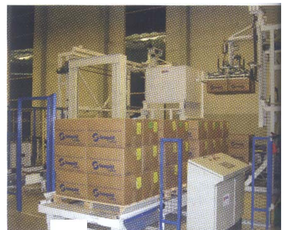
Bild 1. Ein Roboter nimmt die Kartons Lage für Lage von den Paletten und setzt sie auf Transportwagen ab
